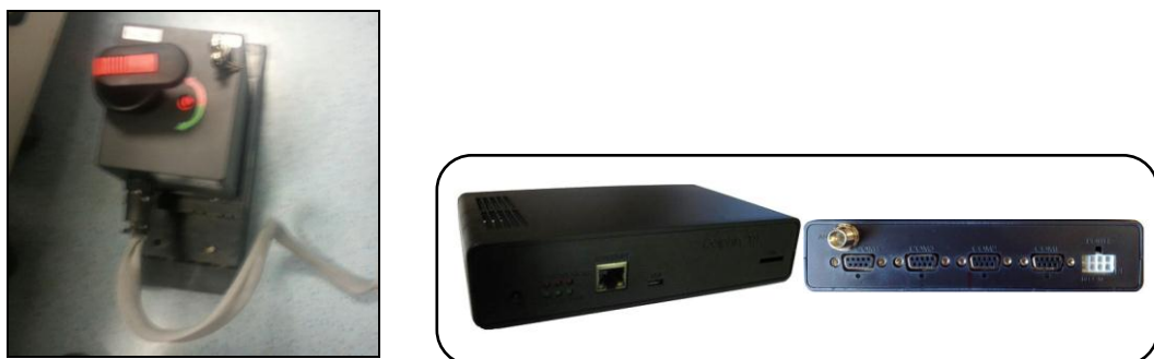
Figura 2: a) motorizzazione per interruttore BT, b) gateway di cabina secondaria (fronte e retro)
